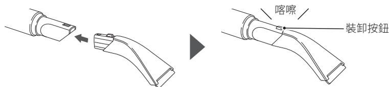
拆下 按下平板吸頭的裝卸按鈕，並同時拆下。
