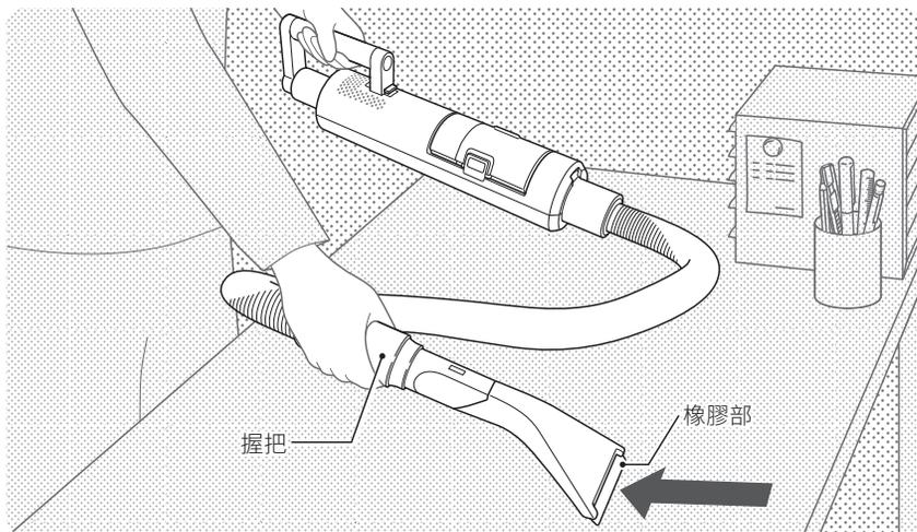
請用單手確實握好手提式握把，另一隻手則握住延長軟管的握把。讓平板吸頭的橡膠部對準要清掃的地方，並慢慢向自己的方向拉的方式移動。前端具有橡膠，能確實吸入灰塵，便於平坦表面的清掃。
