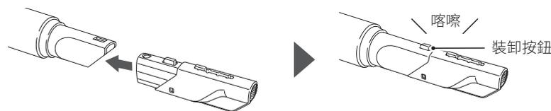
3. 毛刷的長度能 3 段式調整。按下突起部同時滑動，便能調整長度。
